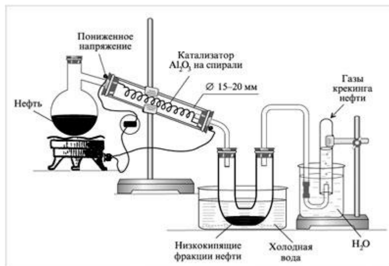
Схема получения в лабораторных условиях жидких и газообразных продуктов перегонки нефти
