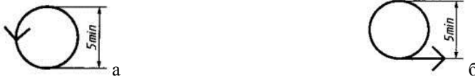
Рисунок 8 – Условное обозначение а -«повернуто», б - «развернуто» Соотношение размеров стрелок, указывающих направление взгляда, должно соответствовать приведенным на рисунке 9.
