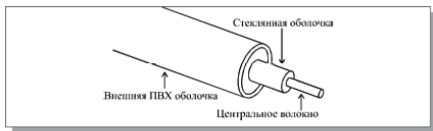
Рис. 3.3 – Структура оптоволоконного кабеля
