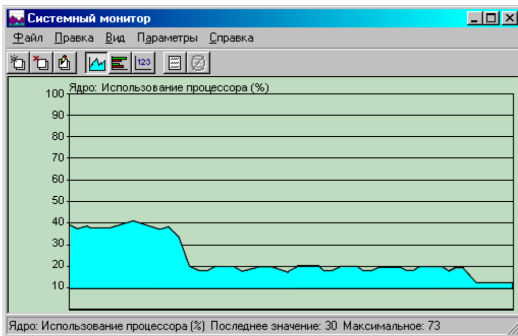
Рис. 3.19. Загрузка процессора при отображении циклически сменяющихся изображений с различными задержками
