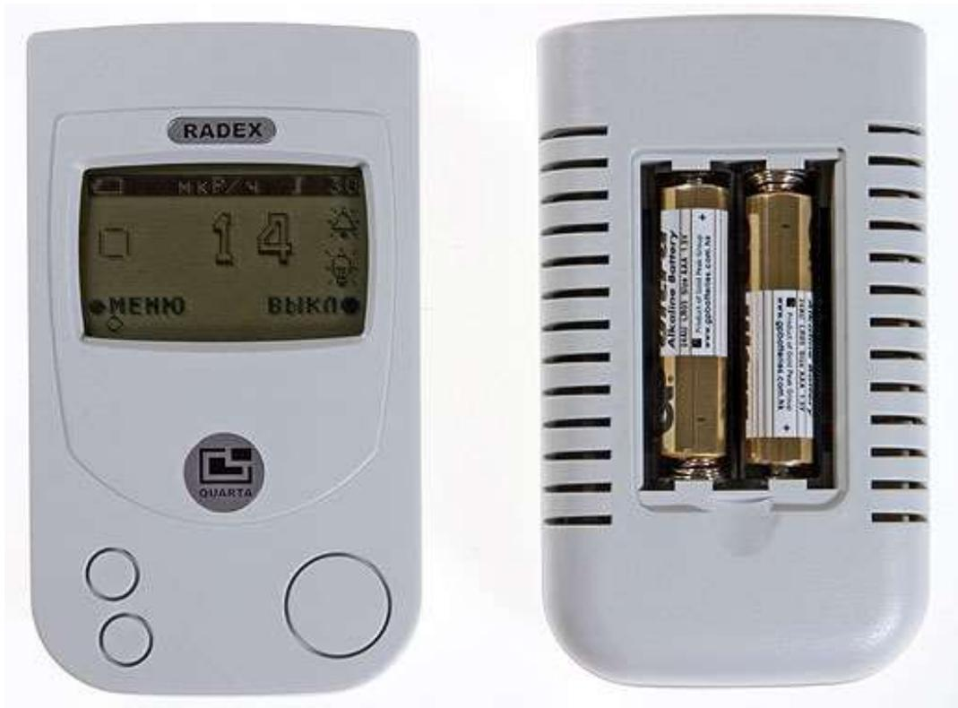
*Рис.3.* Прибор для измерения уровня радиации – дозиметр бытовой
