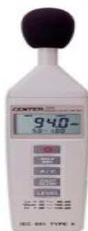
Рис.2. Прибор для измерения уровня шума – шумомер Инструкция по проведению измерений
