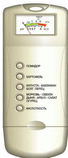
Рис.4. Прибор для измерения нитратов - нитратомер
